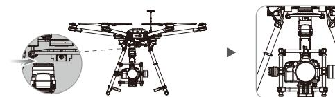
! Ronin-MX が適切にしっかりと取り付けられ、すべてが正しく接続されて Ronin-MX の動きを妨げないことを確認します。
